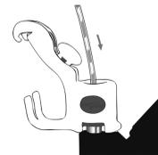
Figur 3: Fixering av styrtrådar genom att vira styrtråden runt fixeringsgaffeln:
