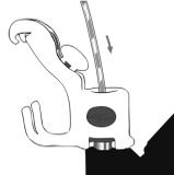
Figura n° 3: Fissaggio del filo guida rivoltandolo sulla forcella di fissaggio:
