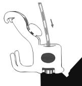
Ilustracija br. 3: Fiksacija uvodnih žica omotavanjem uvodne žice na vilicu za fiksiranje:
