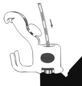
Ryc. nr 3: Unieruchomienie drutów prowadzących przez zwinienie na widełkach ustalających.
