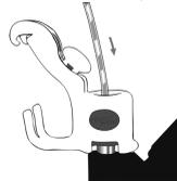
Kuva nro 3: Ohjaukskaapeleiden kiinnitys käärinällä ohjaukskaapeli kiinnityshaarukan ympärille.
