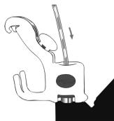
Figura Nr. 3: Fixarea firelor de ghidare prin răsucirea firului de ghidare pe furca de fixare:
