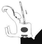
3. ábra: A vezetődrtó rögzítése a vezetődrtó rögzítővillán való visszahajtásával:
